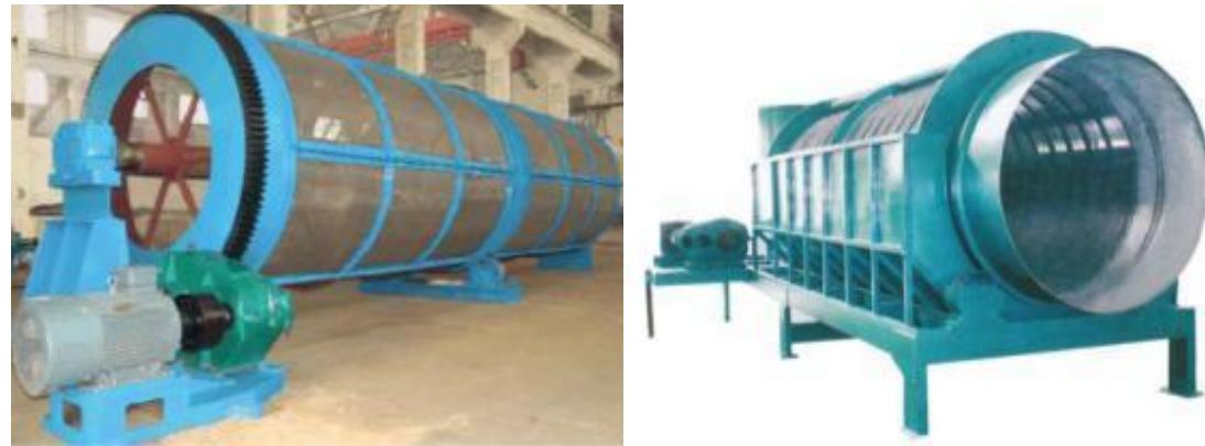
图 7-9 滚筒筛示意图
