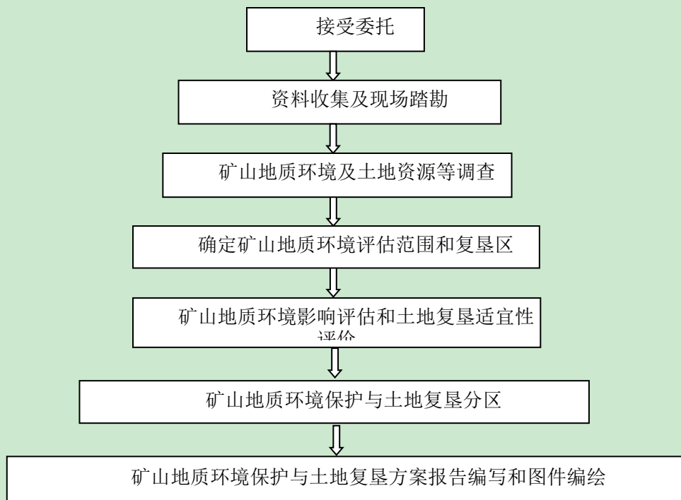
图0-1 矿山地质环境保护与土地复垦方案报告编写工作程序框图
